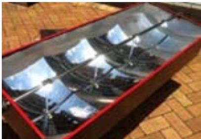
● 聚光光伏CPV是利用光学部件将太阳光聚焦到一个较小面积的高效光伏电池上，从而提高光伏转换效率并可达节省成本之目的。
